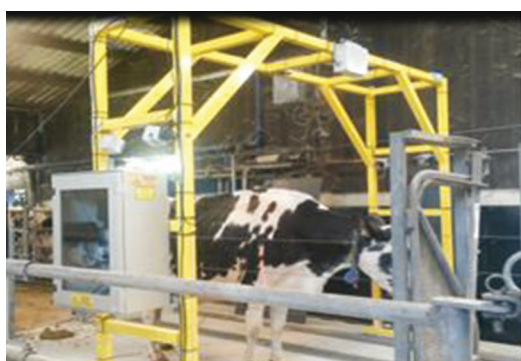
Figure 3. Photo du scanner en train d'acquérir la forme d'une vache (à gauche) et le résultat du scan complet (à droite) visualisé et traité avec le logiciel Meshlab ( http://www.meshlab.net/ ) (photo : P. Faverdin).
