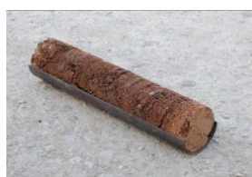
Dimension d'une carotte de terre L = 330 mm – Ø 70 mm Volume = 1.2l
