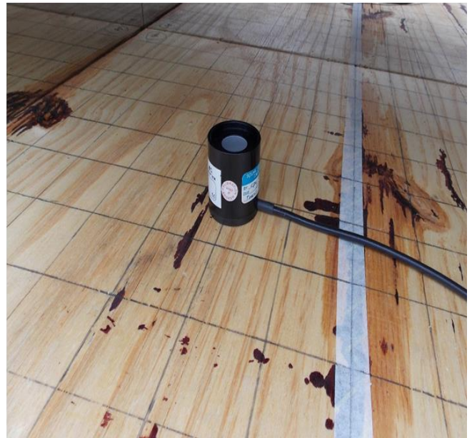
Figure 7. A) Photomètre/radiomètre SOLAR LIGHT PMA 2100 utilisé pour réaliser les mesures des rayonnements. B) Capteur PMA-2122 (UV Germicidal Detector) utilisé. (Photos Marine Forges, INRA PACA et Université d'Avignon et des Pays de Vaucluse).
