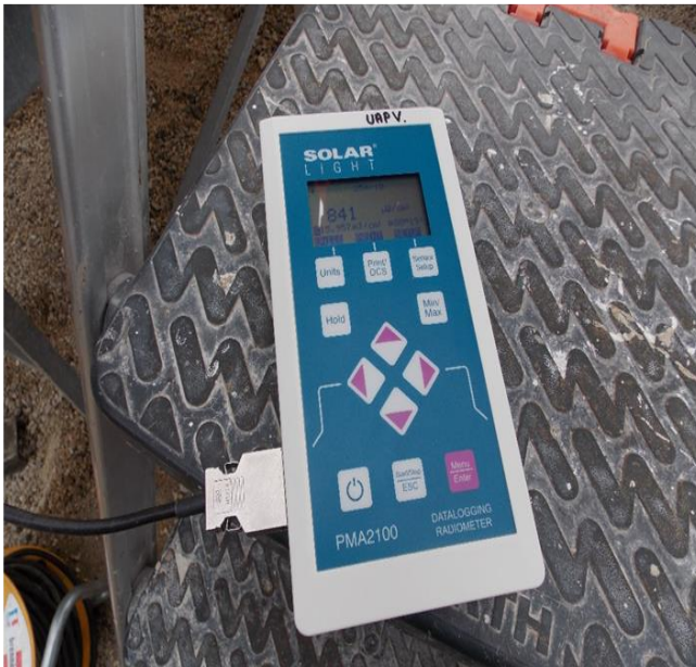
Figure 7. A) Photomètre/radiomètre SOLAR LIGHT PMA 2100 utilisé pour réaliser les mesures des rayonnements. B) Capteur PMA-2122 (UV Germicidal Detector) utilisé. (Photos Marine Forges, INRA PACA et Université d'Avignon et des Pays de Vaucluse).
