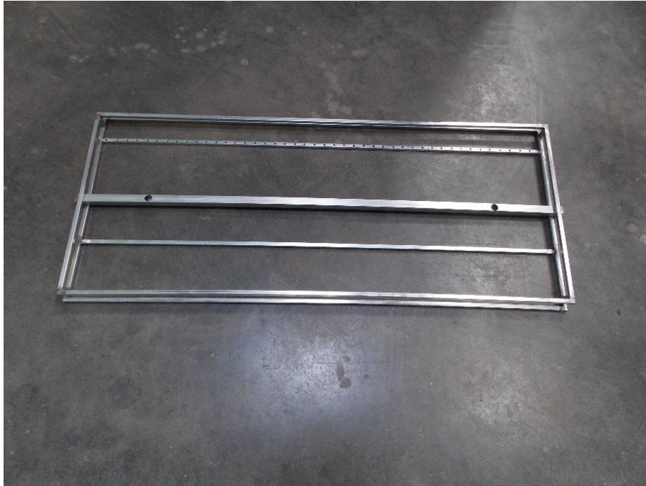
Figure 3. Châssis support des lampes et des ballasts. (Photo : Frédéric Pascal, INRA PACA).
