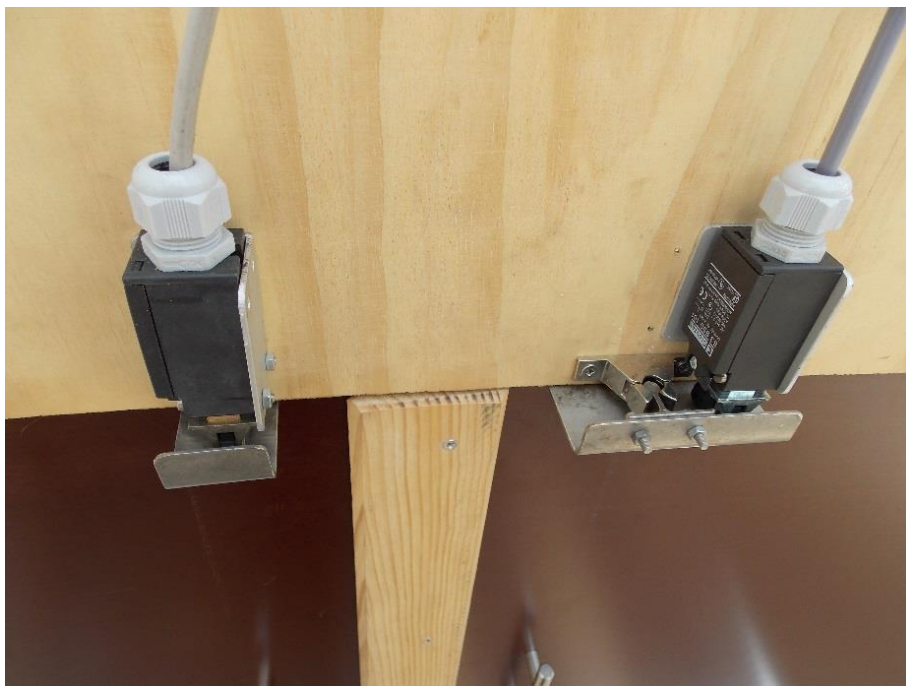
Figure 6. Contacts de sécurité des portes et du loquet de maintien. (Photo : Frédéric Pascal, INRA PACA).
