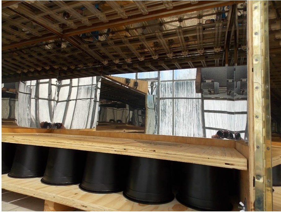
Figure 2. Étagère amovible permettant d'ajuster la distance entre les plantes et les lampes UV-C. (Photo : Frédéric Pascal, INRA PACA).
