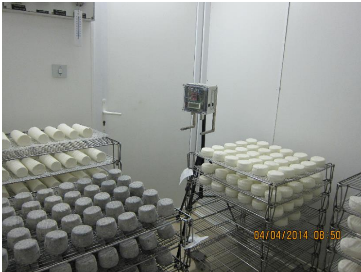
Figure 4 : Enregistrement des paramètres d'ambiance par un prototype développé par l'INRA GMPA Versailles-Grignon.
