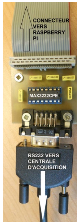
Figure 6. Platine de connexion entre le Raspberry Pi et une centrale d'acquisition (photo : J. Cartailier).
