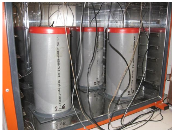
Figure 2. Test de l'effet température sur la qualité du signal en conditions contrôlées ; (Photo : P. Thiébeau).
