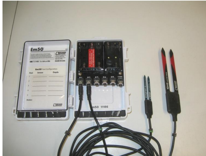
Figure 1. Présentation du matériel utilisé : centrale EM50, capteur EC5 et capteur 10HS ; (Photo : P.Thiébeau).
