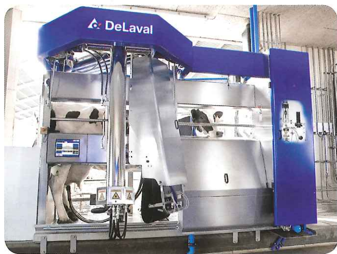
Chez DeLaval, le programme de management Delpro centralise et valorise les données fournies par les capteurs. Herd-Navigateur est un mini-laboratoire à la ferme qui, à partir de l'analyse du lait, apporte des informations sur la fertilité, le déficit énergétique, la santé mammaire et l'équilibre de la ration.
