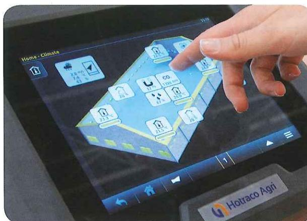
Les bâtiments avicoles sont équipés d'appareils de contrôle, de capteurs et d'un ordinateur qui aident l'éleveur à maîtriser les conditions climatiques (l'ambiance) dans l'élevage.
