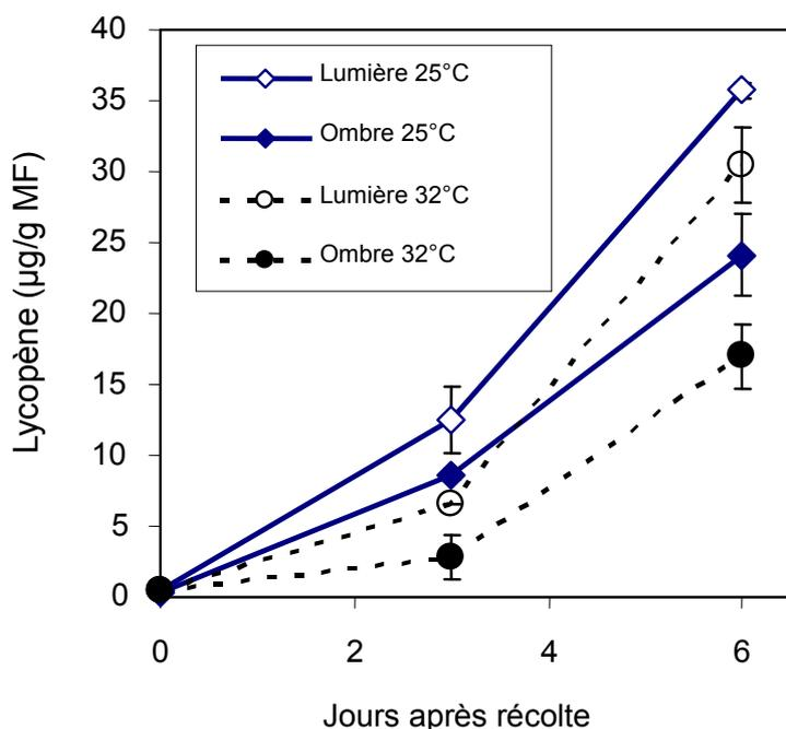
**Figure 4 :** Effet des facteurs lumière et température sur l'accumulation du lycopène chez la tomate d'après Gautier *et al.* (2008). Les expérimentations ont été conduites sur des fruits détachés placés en conditions contrôlées pour éviter les confusions dues à des interactions entre organes et entre processus. Les fruits ont été détachés en début de maturation au stade vert mature (voir Figure 2), puis les deux niveaux de lumière et température ont été appliqués pendant 6 jours.
