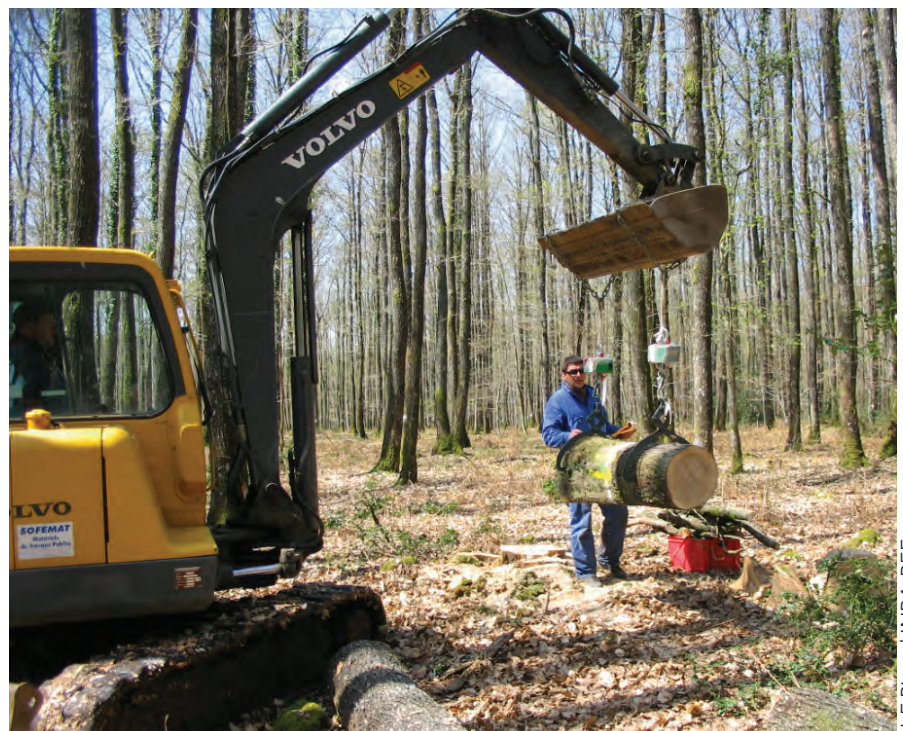
Fig. 1 : campagne de mesures de biomasse-minéralomasse à Montiers sur Saulx (à gauche) et à Bercé (à droite) Une campagne de mesures de 100 arbres de taille moyenne (30 cm de diamètre) nécessite environ 15 ETP sur le terrain pendant 3 semaines.
