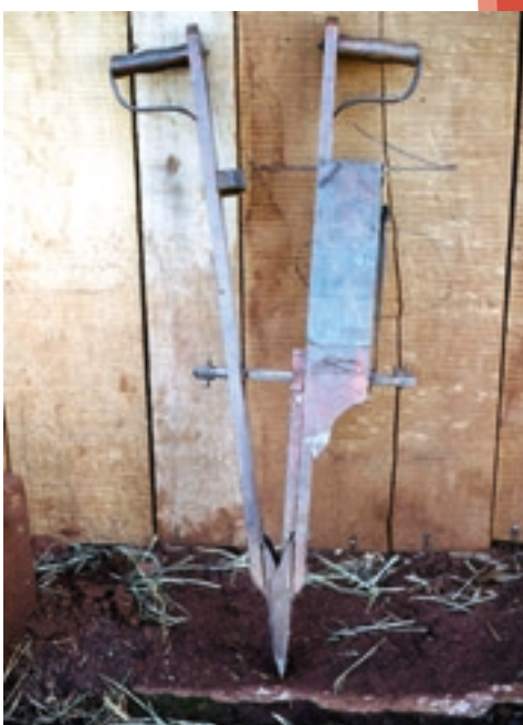
▲ Du taca-taca semoir manuel utilisé par les paysans sur les terres retirées à la forêt native... © C. Albaladejo
