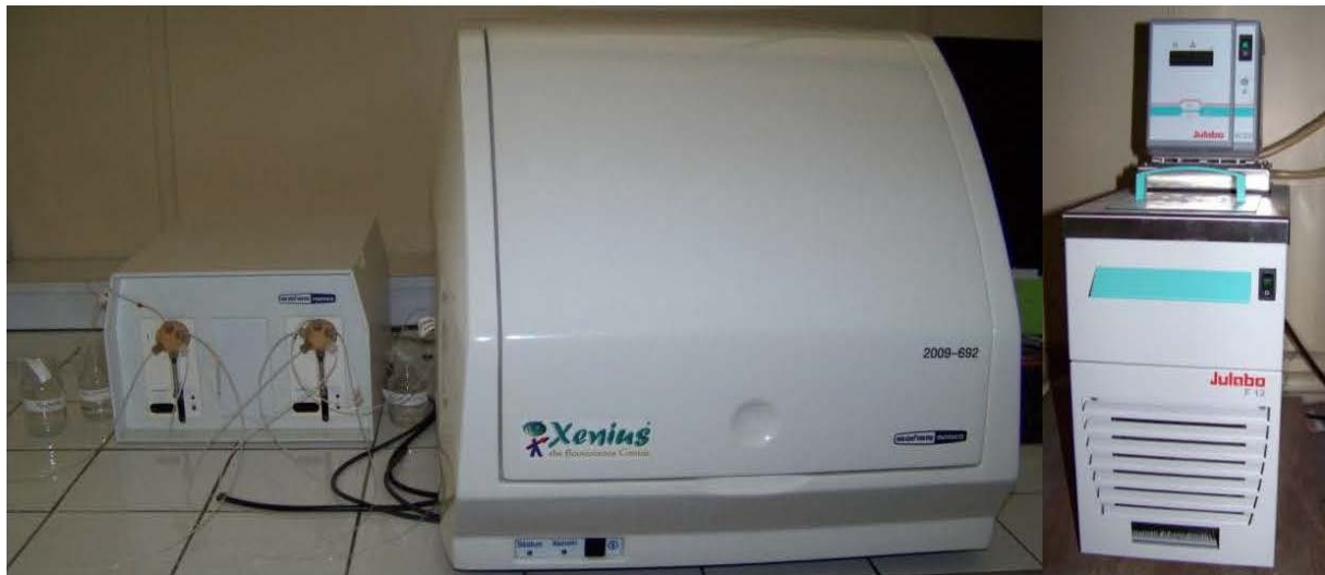
Figure 1. Spectrophotomètre avec lecteur de microplaques, système d'injection automatique et bain thermostaté.
