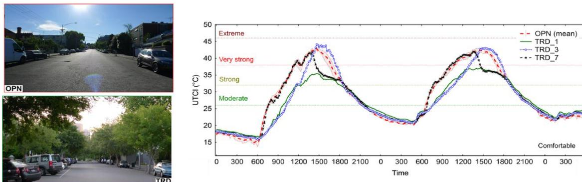
**Figure 9** : Dynamique journalière d'un index de confort thermique (UTCI) calculé dans deux situations configurations différentes : rue avec très peu de végétation (OPN) et rue avec des arbres d'alignement adultes (TRD). Comparaison entre la moyenne du site OPN (4 capteurs) et 3 capteurs sur le site TRD (Coutts et al., 2015).
