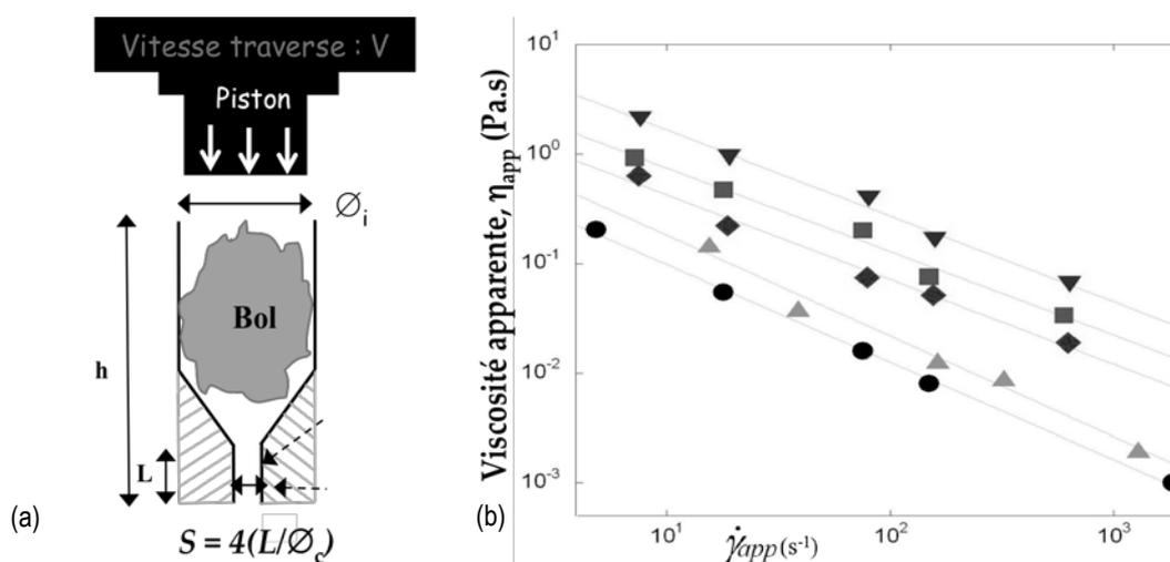
**Figure 3** : Principe de la méthode de rhéométrie capillaire : (a) mesure de la force d'extrusion et (b) variations de la viscosité apparente déduite des mesures de force effectuées pour différentes vitesses  $V$  et dimensions de filière ( $\varnothing_c$ ) (soit pour 5 vitesses de déformation apparente,  $\dot{\gamma}_{app}$ ), aux différents cycles de mastication 0 (▼), 3 (■), 6 (◊), 12 (▲) et SP (●) (Le Bleis *et al.*, 2013).
