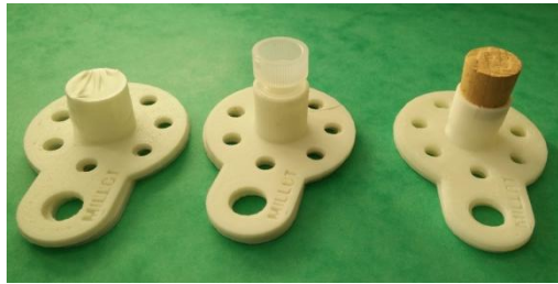
Figure 3. Premiers prototypes reçus, avec bouchons en Parafilm M, en plastique transparent et en liège.
