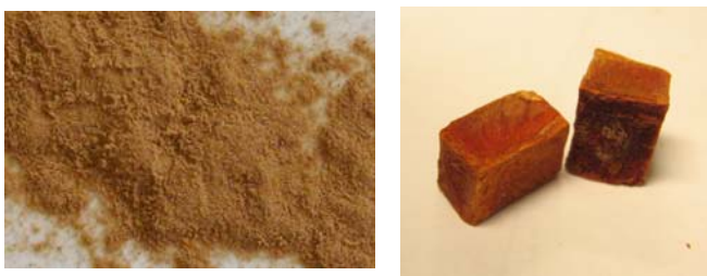
Figure 11 : Tannins en poudre (à gauche), et aérogels de tannin (densité 0.07 \text{ g/cm}^3 , à droite)
