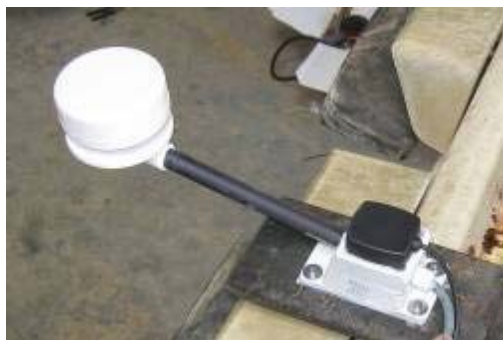
Figure 2 : Station météo & GPS
