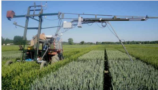
Figure 4 : Le système supportant 3 spectroradiomètres et 2 appareils photos équipés de flashes, le tout porté par un tracteur.
