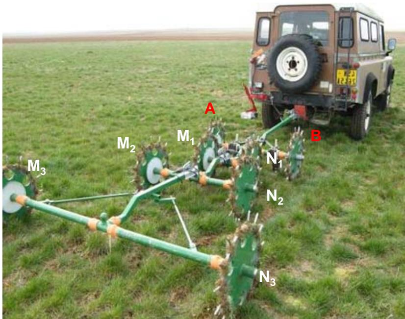
Figure 4 : MuCEP (Multi-Electrode Resistivity Profiler) avec ses quatre trains d'électrodes (AB, M<sub>1</sub>N<sub>1</sub>, M<sub>2</sub>N<sub>2</sub>, M<sub>3</sub>N<sub>3</sub>).
