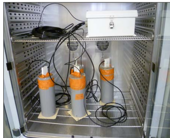
Figure 3. Instrumentation et mise en place des sondes CS616.
