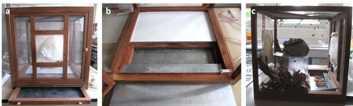
Figure 4. a) Face avant de la cage avec ouverture en tulle et tiroir coulissant à fond inox, b) Fond de cage en contreplaqué avec plaque inox coulissante au dessus du tiroir, et c) Vue de la cage aménagée avec un nid secondaire installé côté plexiglas © INRA.
