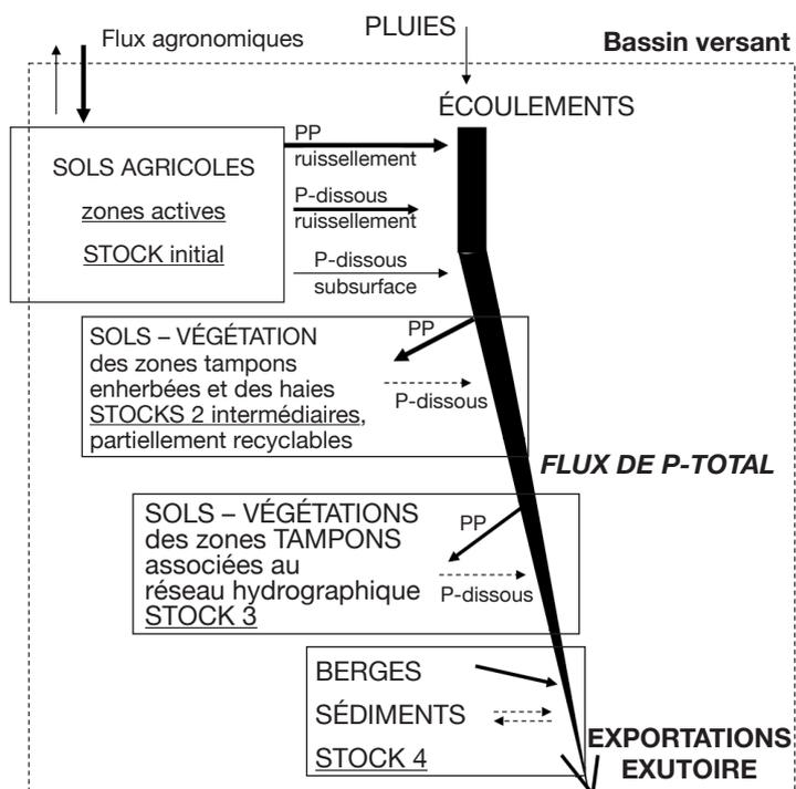
**Figure 4.** Représentation schématique du système de transfert de P à l'échelle du bassin versant (tête de bassin) — *Schematic representation of the transfer system P across the watershed (headwater).*
