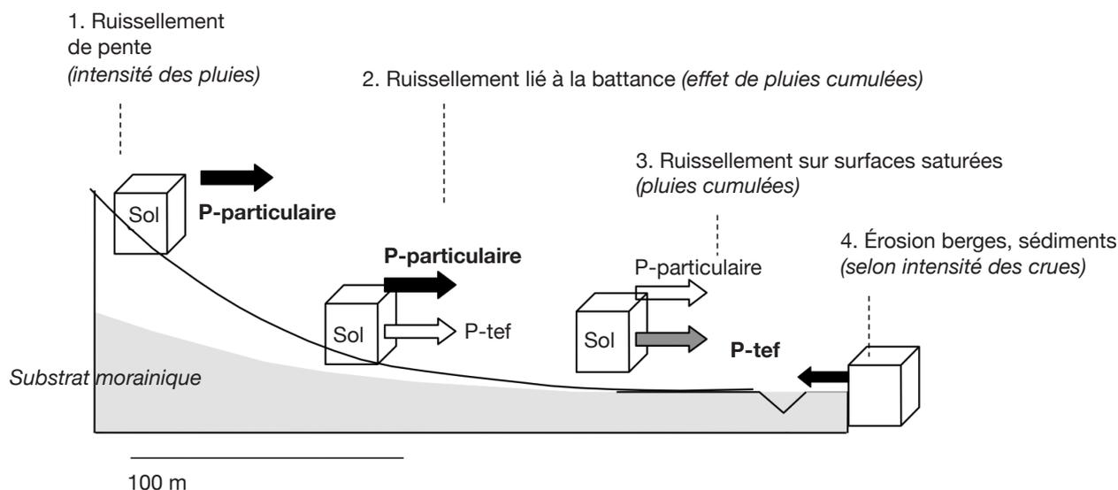
**Figure 1.** Exemple type de variabilité des transferts de phosphore des sols aux eaux de surface, en zone de culture et à l'échelle du bassin versant ; relation avec la variabilité du ruissellement — *Typical variability of phosphorus transfer from soil to surface water in crop area and catchment scale; relationship with the variability of runoff.*
