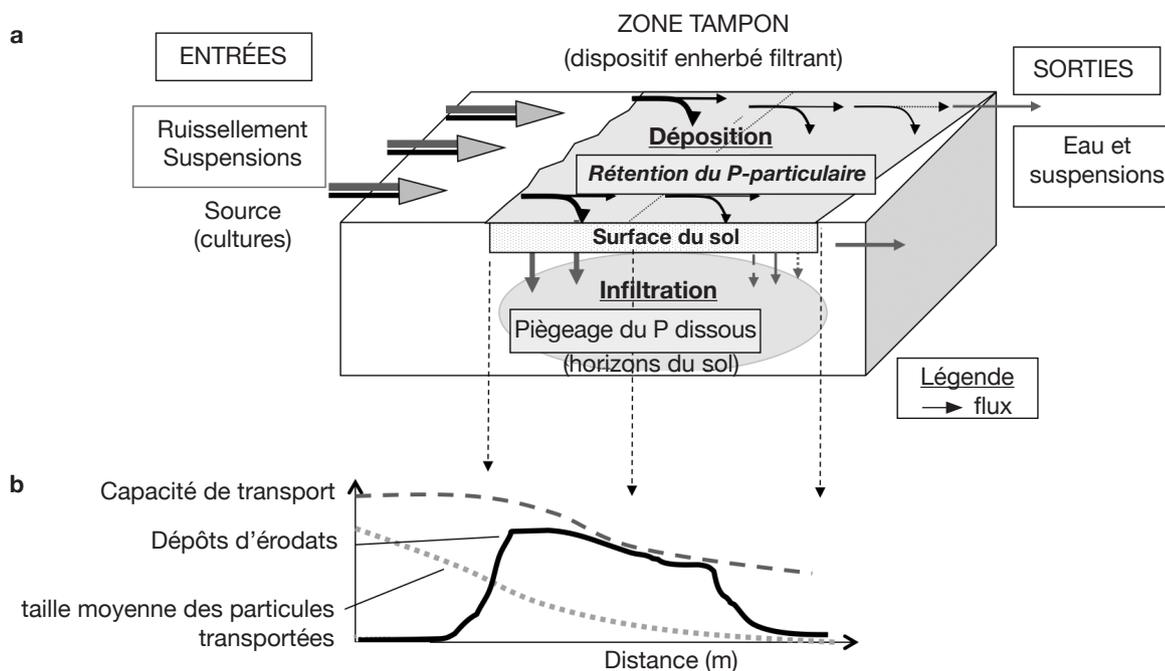
**Figure 3.** Fonctionnement d'une zone tampon type, le dispositif enherbé filtrant ; **a** : distribution spatiale des processus ; **b** : conséquences sur le transport en suspension — *Operation of a buffer type, grassed filter device; a: spatial distribution of the process; b: impact on transport in suspension.*
