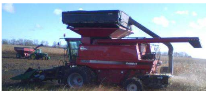
Figure 5 : Le système Top Tank développé par Case collecte rafles et spathes.
