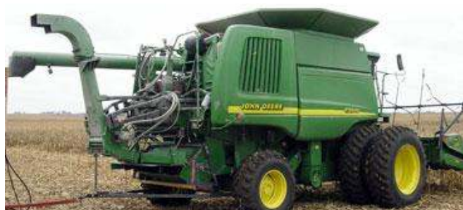
Figure 6 : Le bec de l'équipement John Deere/Hillco peut être dirigé sur le côté ou derrière.
