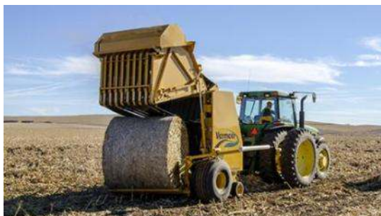
Figure 1 : Vermeer a développé une presse spéciale pour la collecte des rafles en andains.
