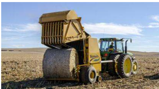
Figure 1 : Vermeer a développé une presse spéciale pour la collecte des rafles en andains.
