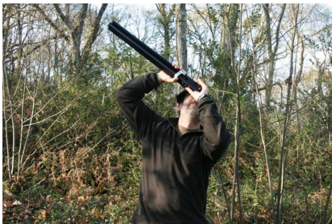
Photo 4. Mesure au pentaprisme de Weelher
