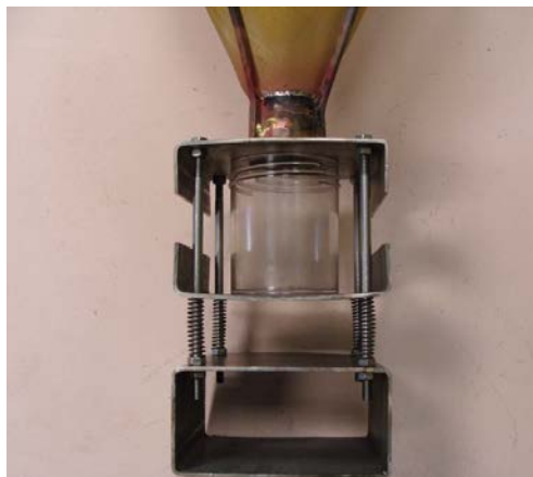
Figure 8. Détail du porte-pot de collecte d'insectes.
