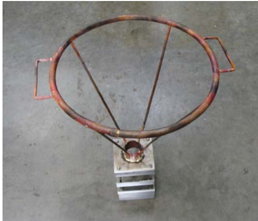
Figure 6. Détail de l'armature en cuivre du collecteur d'insectes.
