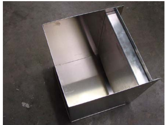
Figure 4. Caisson d'aspiration en cours d'assemblage : vue du dessus permettant de voir à droite la cloison latérale provoquant l'aspiration d'air par le fond.
