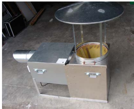
Figure 10. Piège à aspiration terminé.
