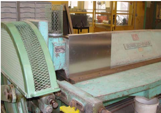
Figure 3. Pliage des tôles.
