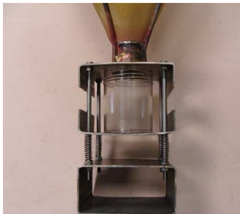
Figure 8. Détail du porte-pot de collecte d'insectes.
