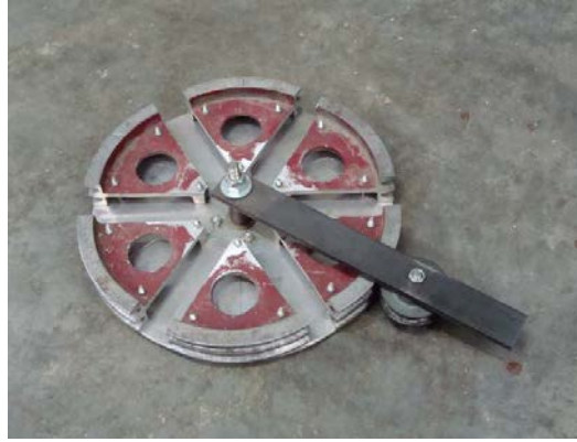
Figure 9. Cintreuse conçue à l'atelier.
