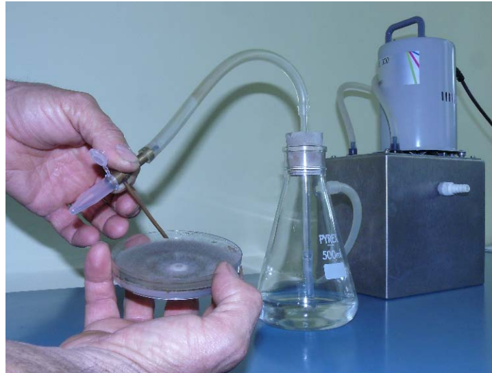
Figure 4. Récolte de spores de Botrytis cinerea à sec à l'aide du mini aspirateur.
