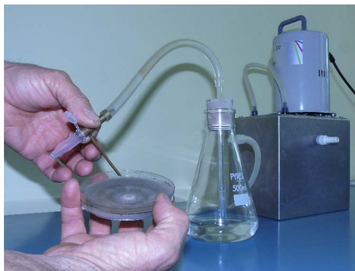
Figure 4. Récolte de spores de Botrytis cinerea à sec à l'aide du mini aspirateur.
