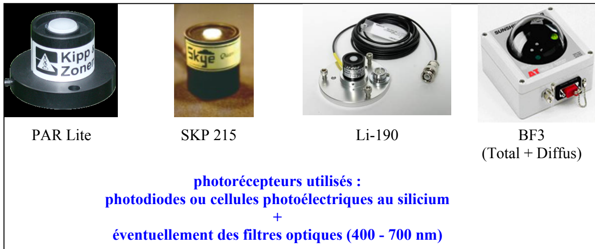
Figure 13 : Exemple de capteurs utilisés pour la mesure du rayonnement visible
