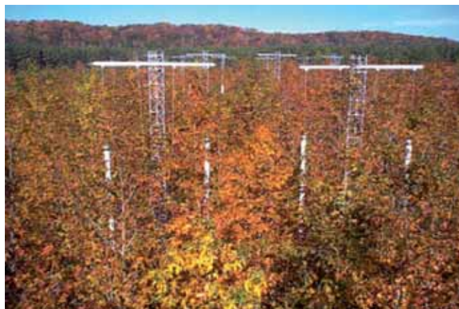
Le système d'enrichissement en CO 2 (FACE) à Oak Ridge (Tennessee, USA) sur des espèces forestières tempérées feuillues américaines. Source : http://www.esd.ornl.gov/facilities/ORNL-FACE/
