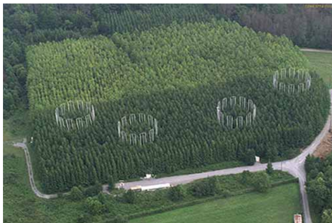
Le système d'enrichissement en CO 2 (FACE) à Oak Ridge (Tennessee, USA) sur des espèces forestières tempérées feuillues américaines. Source : http://www.esd.ornl.gov/facilities/ORNL-FACE/
