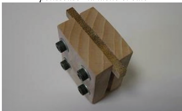
Photo 9 © Inra/P. Marchal : cale de ponçage, détail rainure
