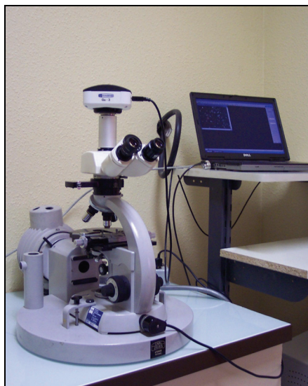
Photo 1 : Microscope Zeiss Standard 14 associé à une caméra Qimaging, capteur CMOS 3 Mo Pixel connecté à un ordinateur portable via un port USB2
