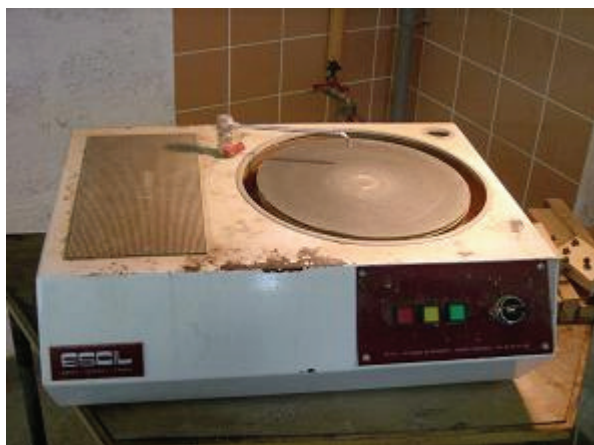
Photo 6 © Inra/P. Marchal : polisseuse manuelle
