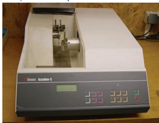
Photo 4 © Inra/ Patrice Marchal : tronçonneuse Accutom-5
