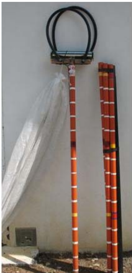
Photo 4 et 5 © Inra/G. Roussel : perche équipée d'une servante et de tuyaux rigides servant de guide lors du passage de la « chaussette »
