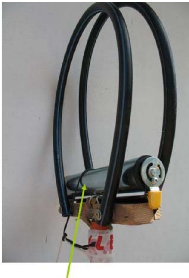
Photo 4 et 5 © Inra/G. Roussel : perche équipée d'une servante et de tuyaux rigides servant de guide lors du passage de la « chaussette »
