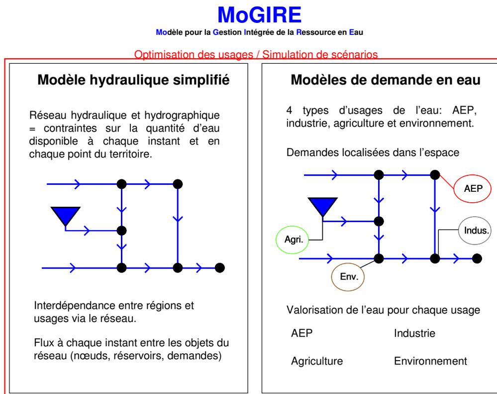
**Figure 4** : Architecture générale du modèle MOGIRE
