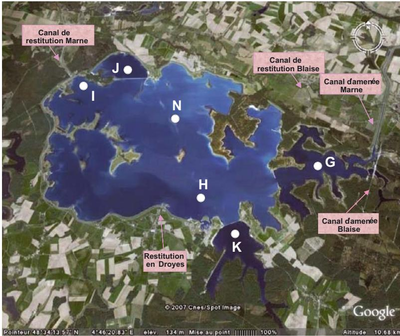
**Fig. 1.** Carte du Réservoir Marne présentant les deux lacs (lac du Der et lac de Champaubert), les deux bassins à vidange différée (Nord-Ouest et Sud-Est), les deux canaux d'amenée (Marne et Blaise), les deux canaux de restitution (Marne et Blaise) et la restitution en Droyes (Source : Google Earth, 2008). Les lettres représentent les stations d'échantillonnage : H (station Giffaumont), I (tour de restitution), N (lac du Der), G (lac de Champaubert), K (bassin sud-est), J (bassin nord-ouest).
