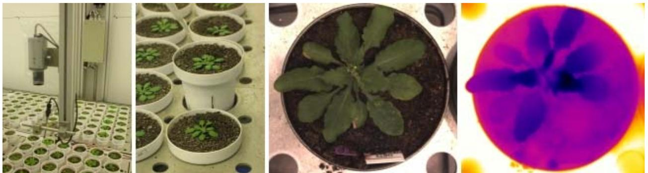
Figure 1 : **a-** Automate dans PHENOPSIS 1, **b-** Pesée et irrigation d'un pot, **c-** Photo numérique prise dans le visible par l'automate, **d-** Photo prise dans l'infrarouge par l'automate dans PHENOPSIS 3
