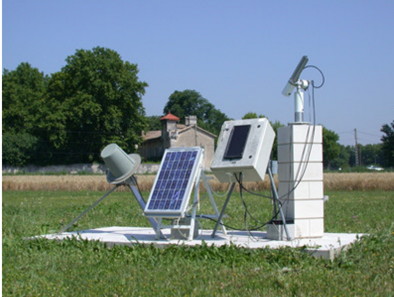
Figure 5 : photomètre solaire CIMEL CE318 utilisé dans le réseau AERONET Centre Inra d'Avignon
