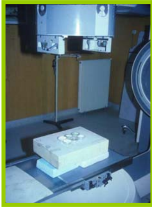
Photo 3: Appareil de radiothérapie : le champ d'irradiation est petit, il correspond à la surface de la boîte en polystyrène blanc. Seulement quelques boîtes de Pétri peuvent être irradiées en même temps.
