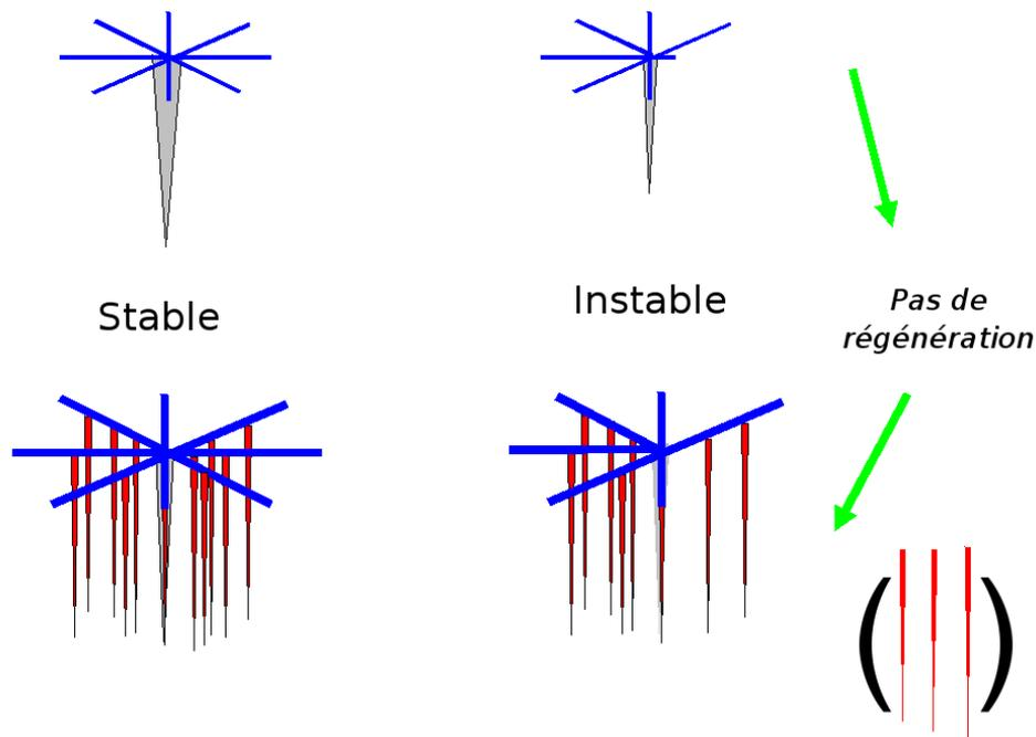
**Figure 2** : Système racinaire du type pieux haubanné dans jeune (haut) et de type cage haubannée âgé (bas), sans racines obliques et ne générant pas de racines par développement retardé : si la répartition circulaire des racines de l'arbre jeune n'est pas homogène, la cage sera incomplète et donc instable.
