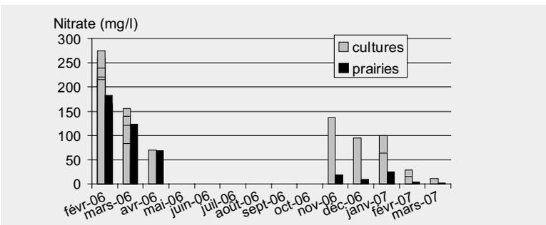
FIGURE 3 : **Dynamique temporelle des concentrations de nitrate collectées par plaque lysimétrique à 105 cm de profondeur de sol, sous cultures ou prairies fauchées** (dispositif ORE-ACBB, site de Lusignan).
