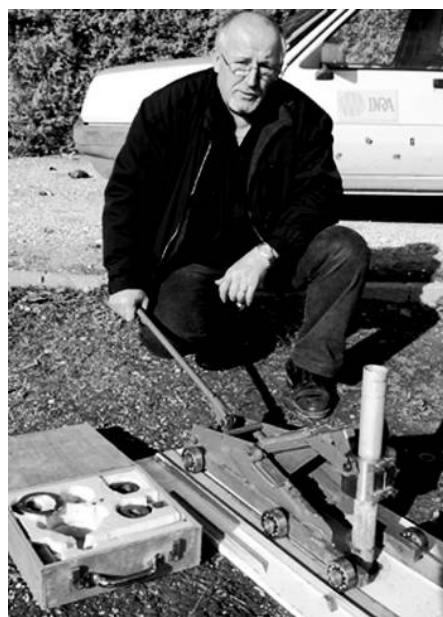
Photo 2 : Extraction d'un tube d'accès neutronique
