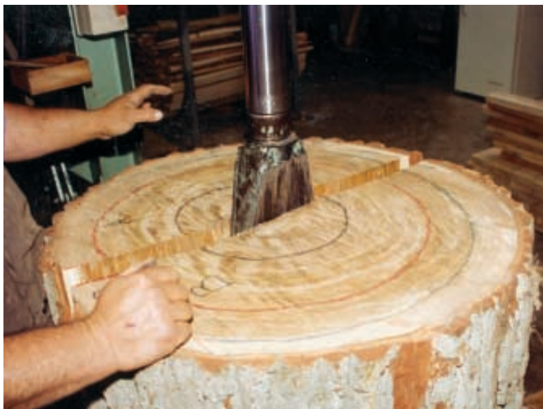
Fente d'un billon en vue de la fabrication du merrain
