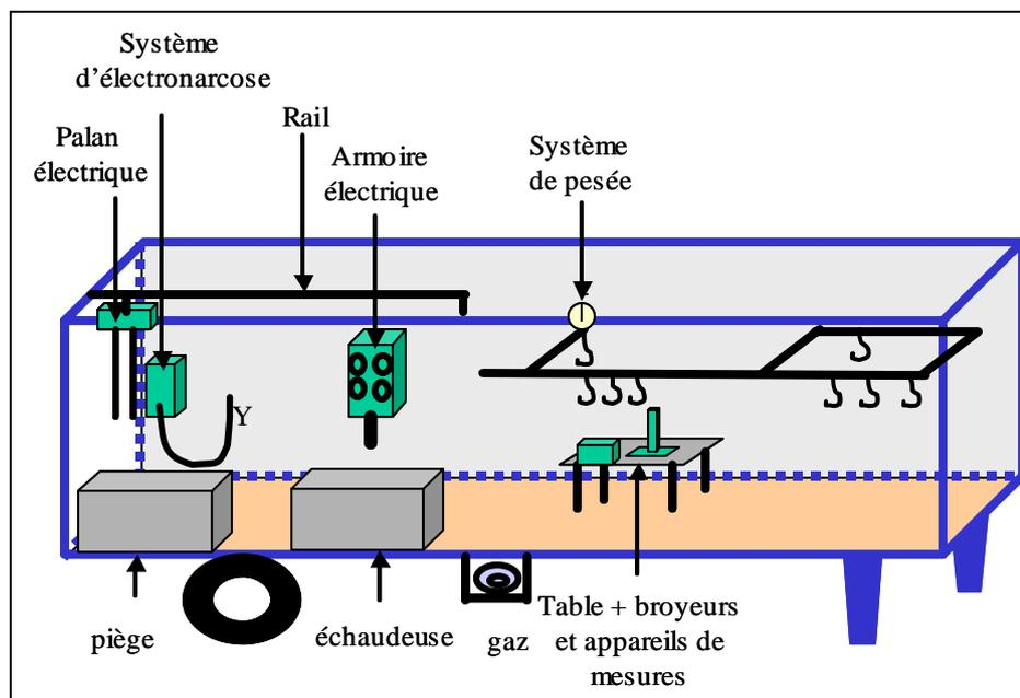
**Figure 1** : représentation schématique de l'abattoir expérimental
