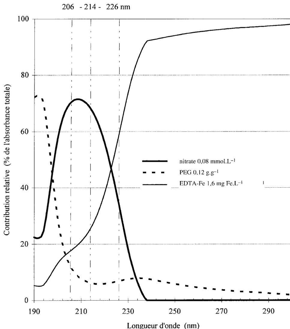
**Fig 7.** Contribution des différentes molécules (nitrate, EDTA-Fe et PEG) en pourcentage de l'absorbance totale d'une solution, dans le cas d'un fort rapport [PEG]/[nitrate].
