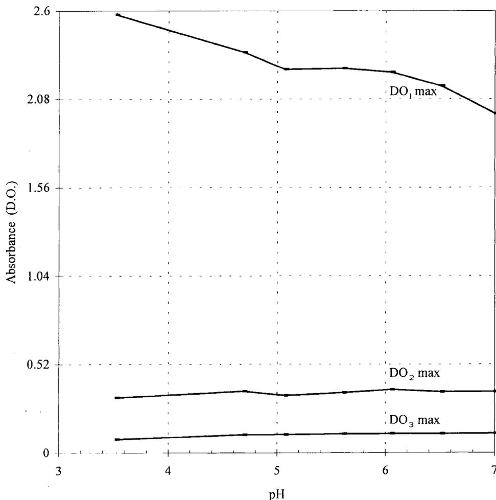
**Fig 3.** Effet du pH sur les trois maxima d'absorbance, indicés dans l'ordre croissant des longueurs d'onde, d'une solution d'EDDHA-Fe à une concentration équivalente à 1,6 mg Fe.L<sup>-1</sup>.
