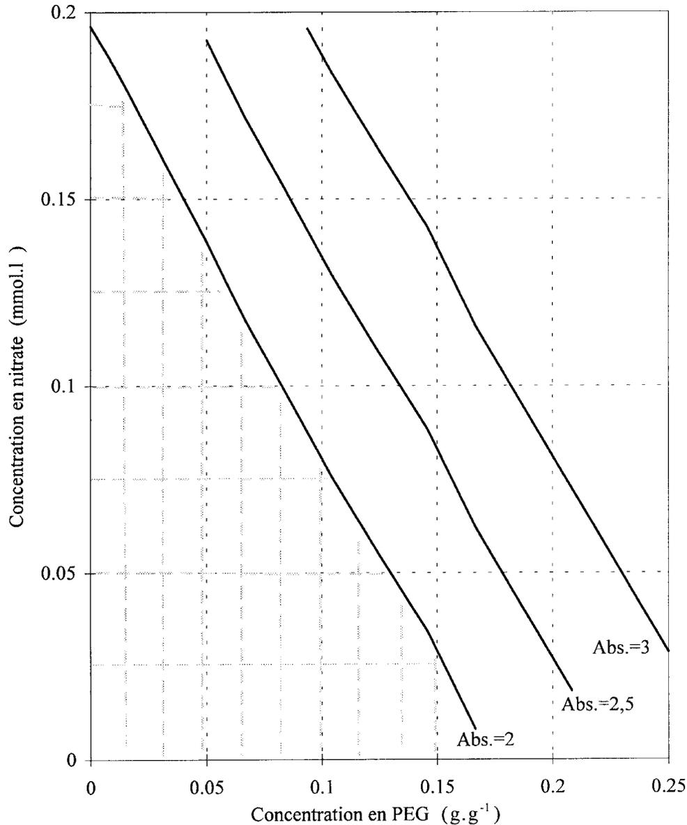
**Fig 8.** Courbes des niveaux d'absorbance totale (Abs) en fonction des teneurs en nitrate et en PEG, en présence d'EDTA-Fe (1,6 mg Fe.L<sup>-1</sup>).
