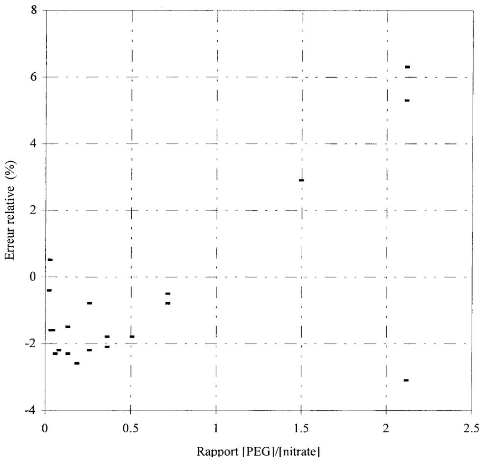
**Fig 6.** Valeurs des erreurs relatives moyennes (quatre répétitions) en fonction des rapports de concentration  $[\text{PEG}]/[\text{nitrate}]$ . Le PEG est exprimé en  $\text{g}\cdot\text{g}^{-1}$  et le nitrate en  $\text{mmol}\cdot\text{L}^{-1}$ .
