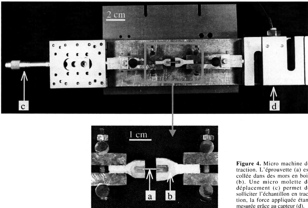
**Figure 4.** Micro machine de traction. L'éprouvette (a) est collée dans des mors en bois (b). Une micro molette de déplacement (c) permet de solliciter l'échantillon en traction, la force appliquée étant mesurée grâce au capteur (d).
