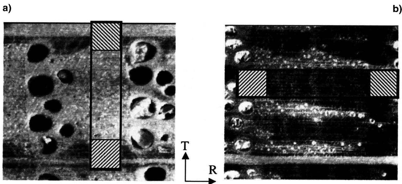
**Figure 3.** a. Échantillonnage d'une zone de parenchyme et petits vaisseaux destinée à un essai mécanique de traction dans la direction tangentielle. b. Échantillonnage d'une zone fibre destinée à un essai de traction dans la direction radiale.
