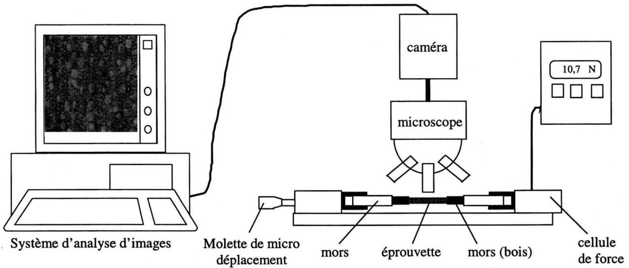
**Figure 1.** Système expérimental d'essai mécanique sous microscope développé à L'Engref. La comparaison d'images avant et après sollicitation permet de calculer le champ de déformation alors que le capteur de force permet d'accéder à la contrainte correspondante.
