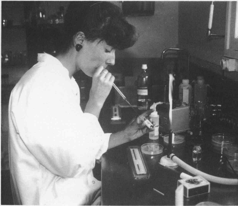
Préparation de milieux de culture réalisés au laboratoire pour la recherche et l'identification des germes.
