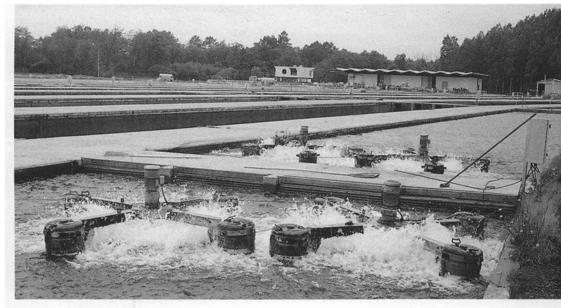
Bassins « couloirs » de 300 m de long alimentés par un captage d'eau de rivière de 2 à 3 m<sup>3</sup>/s (Salmonidés d'Aquitaine). Noter le turbinage nécessaire à la fourniture d'oxygène : les 500 tonnes de poissons en stock consomment environ 300 g d'oxygène dissous par kg d'aliment ingéré.
