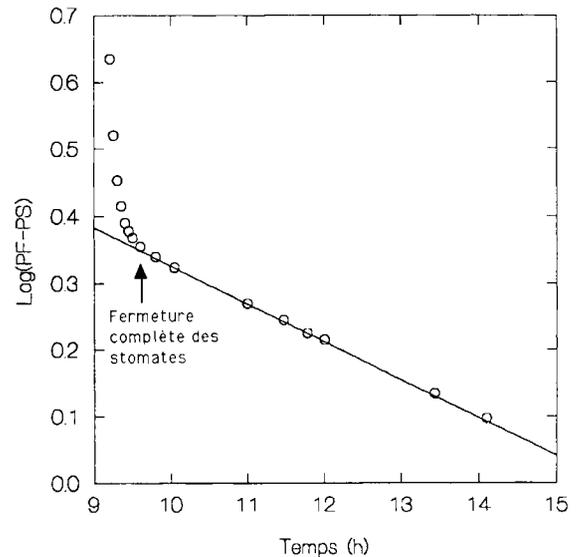
**Fig 1.** Courbe de transpiration typique (d'après Hygen, 1951), représentant le logarithme de la différence du poids frais et du poids sec d'une feuille de rosier en fonction du temps. Les cercles correspondent à des points réels. La droite de régression provient de l'ajustement linéaire des 9 derniers points (phase de transpiration purement cuticulaire).
