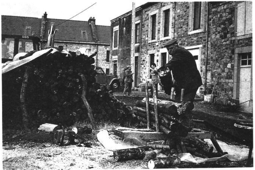
Photo 2. Sciage du bois à l'aide d'un chevalet et d'une tronçonneuse (Photo A. Fortier)
