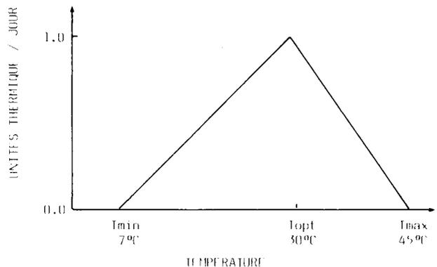
Fig. 2. Calcul de l'unité thermique de développement.
