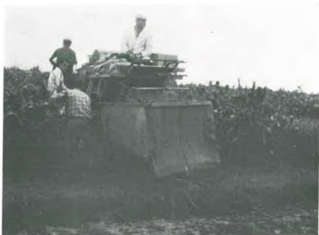
FIG. C. — Récolte des céréales à la moissonneuse-batteuse Vue arrière de la machine, modifiée en vue de la pesée
