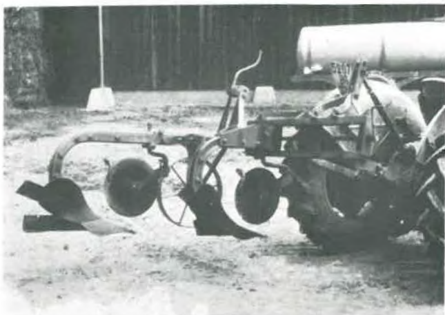
FIG. B. — Charrue entièrement déportable type « vigneronne ». Profil
